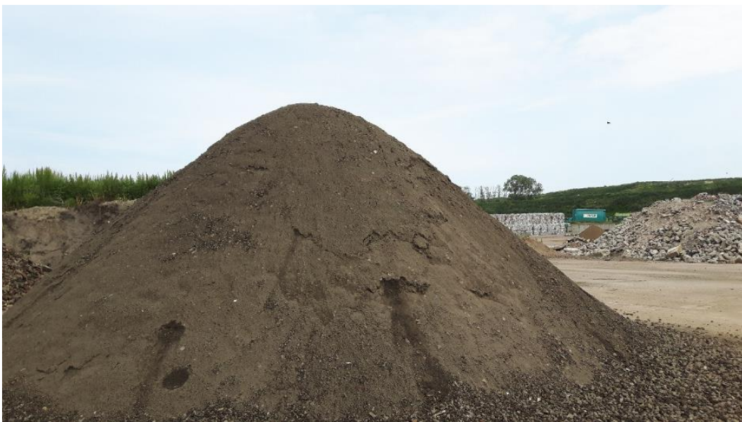
Figur 2.4 Färdigblandad siktad (4 cm) referensjord; ca 21% PAH-förorenad jord från Orienten 7, 79% metall-förorenad jord från Oslopiren och 1% kompost.
