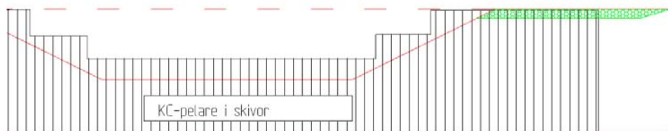
Figur F1:5.22. Typsektion för kalkcementpelarförstärkning.
