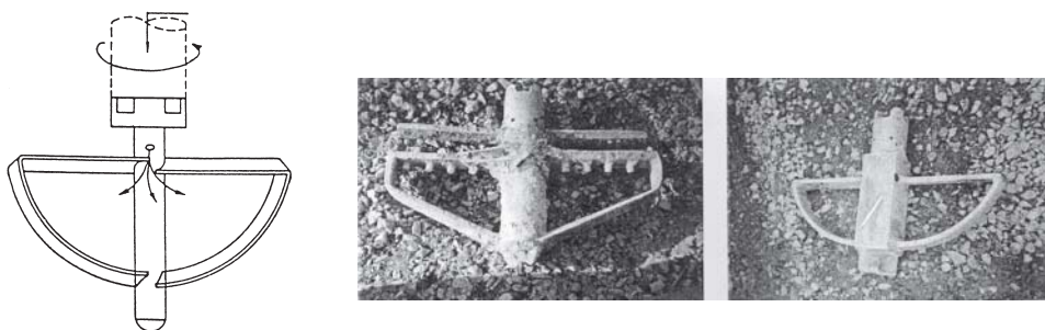
Figur 7.4. Principskiss för det traditionella inblandningsverktyget med halvcirkelformad bygel och skränkta blad samt några andra exempel på inblandningsverktyg.
