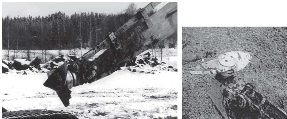
Figur 7.5. Exempel på olika inblandningsverktyg för masstabilisering.
