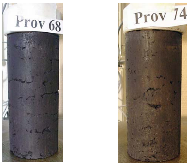
Figur 12. Provkroppar tillverkade under ringtesten på Hummeltorpstorv.
