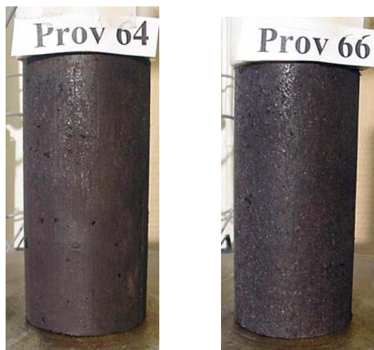
Figur 15. Provkroppar tillverkade under ringtesten på Nexanstorv.
