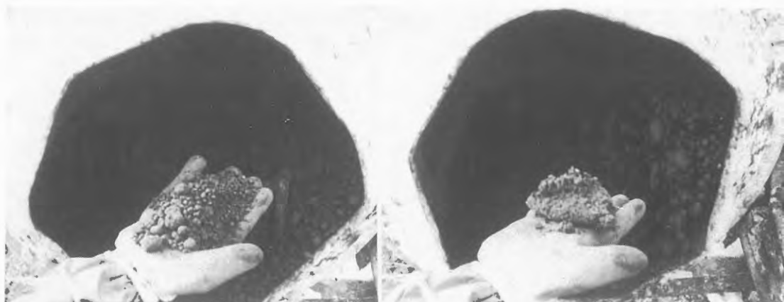
Figur 25. Stenigt väl sorterat isälvs material som blandats med bentonit och vatten till lämplig vattenkvot för packning. Före respektive efter hopkramning av handen.
