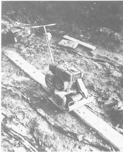
Figur 10. Foto av den vibratorplatta - Dynapac CM 12/13 (145 kg) som använts vid försöken.
