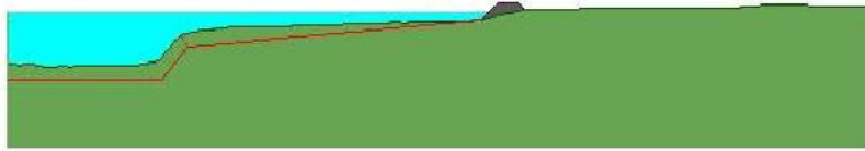
Figur 4-5. Geometriska förändringar för typsektion B1 (slänt med undervattenshylla och med erosionsskydd, alternativ B1-1).
