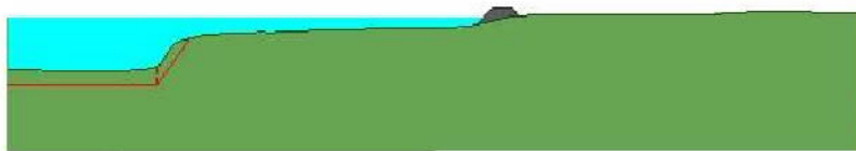
Figur 4-6. Geometriska förändringar för typsektion B1 (slänt med undervattenshylla och med erosionsskydd alternativ B1-2).
