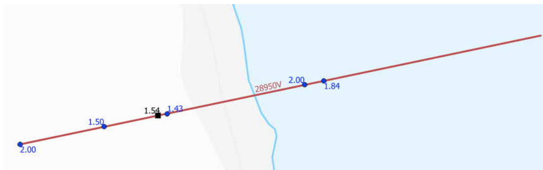
Figur 4-10. Beräkningssektion inklusive markering av glidyornas bakre skärningspunkt för beräknade säkerhetsfaktorer. Blå punkt och siffra avser kombinerad analys, svart kvadrat och siffra avser odränerad analys.
