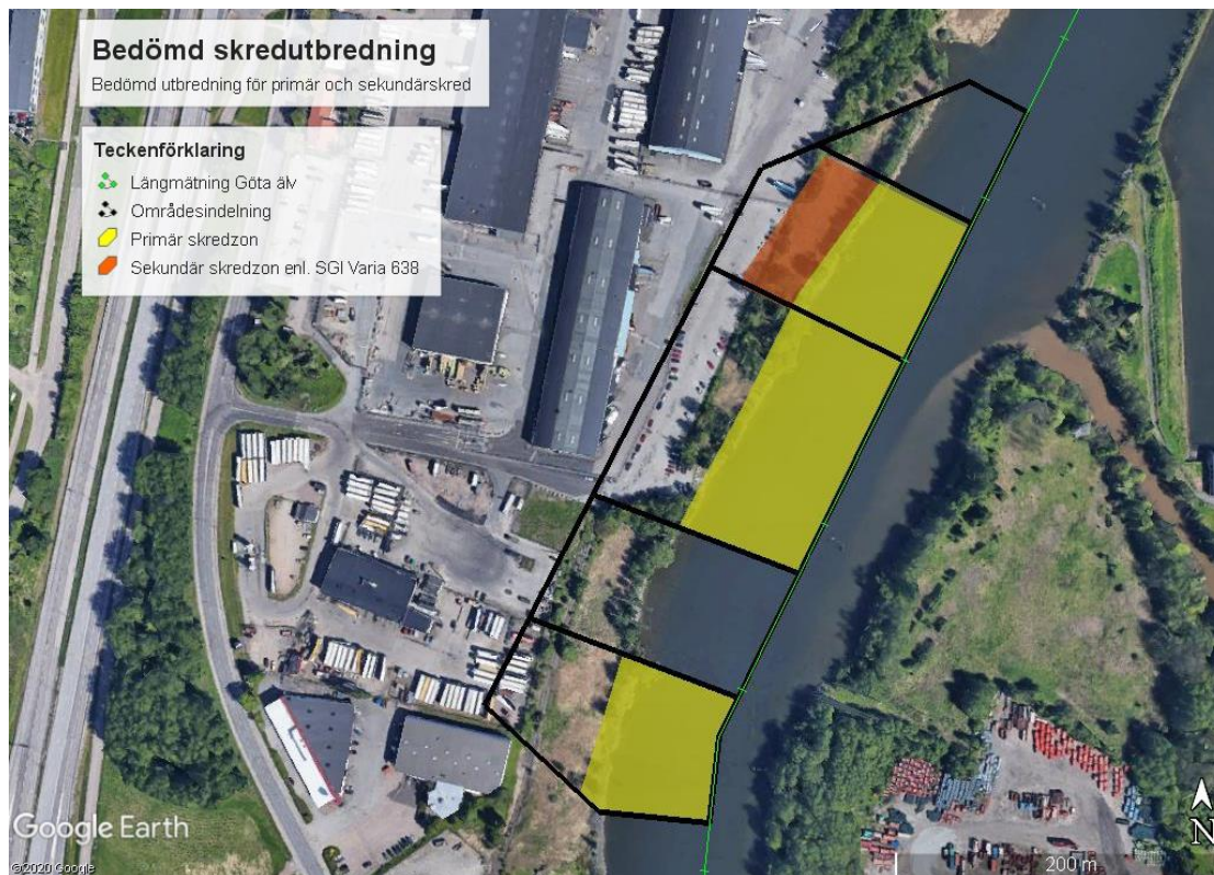
Figur 9-2 Utbredning av primär och sekundär skredzon inom studerat område. (Omarbetad från google earth pro)
