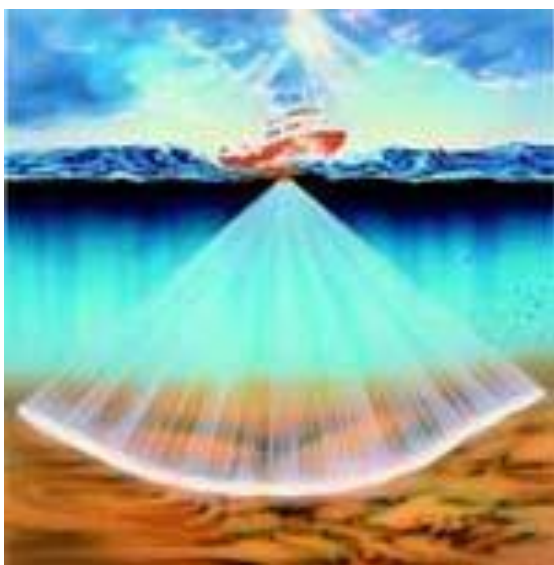
Figur B1-11. Illustration av strålar från ett fartygs multiekolod mot bottenprofilen. ( www.kongsberg.com )
